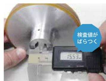
ノギスやマイクロメーターを使った製品の検査は、作業者によって検査値のばらつきが発生し、最終検査で寸法外れなどの不具合が生じます。
